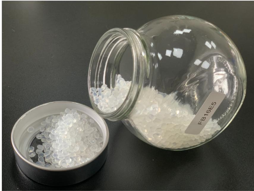
相容剂应用在回收废旧塑料利用相容剂回收废旧塑料，使之成为新的塑料合金或新的改性塑料，是“废物综合利用”比较好的可行办法，并可解决“白色污染”问题，具有很大的社会效益和企业经济效益。在国外已有很多先例，如荷兰国家矿业公司生产的**BENNET**相容剂，就是用于回收废旧塑料再生的自用相容剂，可以把两种或多种不同品种、不同性质的旧塑料，如聚烯烃塑料与工程塑料的边角料的共混再生，添加5%-10%相容剂作为海相或岛相之间的界面层，发挥相容剂的键合力极性相容基团效率，而制备成为一种新的塑料合金或改性塑料。
