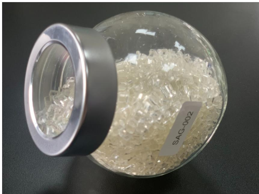
Eco-1120高反应活性,回收塑料扩链剂。再生塑料的高效循环利用一直是企业关注的重点。例如生活中随处可见的PET塑料瓶,如何通过高质量的回收利用,使其远离垃圾埋场、缓解环境压力,是我们需要思考的问题。Eco-1120是一款针对聚酯材料回收利用的高环氧含量的扩链剂,对再生聚酯类材料有良好的增粘、扩链作用,改善加工性能。它能够有效提高聚酯、聚酰胺类材料(如R-PC-R-PET-R-PA)粘度,促进这些材料的高性能循环再利用,减少环境压力。广东无气味PP相容剂如何挑选反应型相容剂能起到很好的相容作用。
