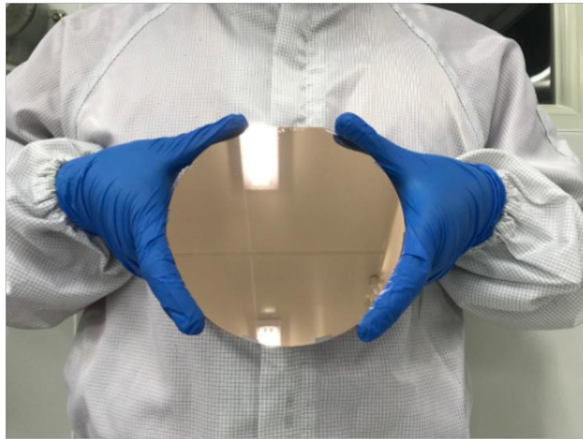
半导体器件生产工艺流程主要有4个部分，即晶圆制造、晶圆测试、芯片封装和封装后测试。晶圆制造是指在硅晶圆上制作电路与电子元件如电晶体、电容体、逻辑闸等，整个流程工艺复杂，主要有晶圆清洗，热氧化，光刻（涂胶、曝光、显影），蚀刻，离子注入，扩散，沉积和机械研磨等步骤，来完成晶圆上电路的加工与制作。晶圆测试是指对加工后的晶圆进行晶片运收测试其电气特性。目的是监控前道工艺良率，降低生产成本。芯片封装是利用陶瓷或者塑料封装晶粒及配线形成集成电路；起到固定，密封和保护电路的作用。封装后测试则是对封装好的芯片进行性能测试，以保证器件封装后的质量和性能。MEMS加工技术：传统机械加工方法指利用大机器制造小机器，再利用小机器制造微机器。天津新能源半导体器件加工费用
