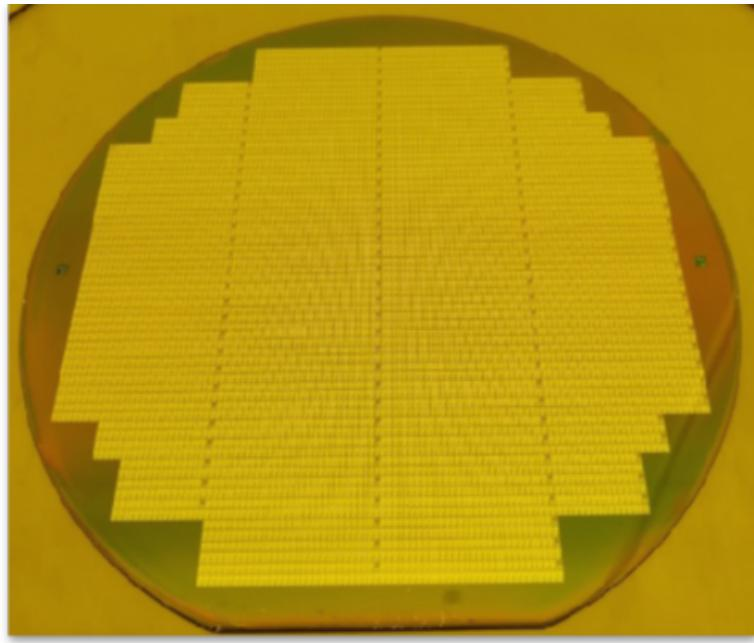
在MEMS制程中，刻蚀就是用化学的、物理的或同时使用化学和物理的方法，在光刻的基础上有选择地进行图形的转移。刻蚀技术主要分为干法刻蚀与湿法刻蚀。干法刻蚀主要利用反应气体与等离子体进行刻蚀；以FATRIUTC为例，在MEMS制造中的ICP刻蚀机主要用来刻蚀Si<sub>3</sub>N<sub>4</sub>、SiO<sub>2</sub>等。湿法刻蚀主要利用化学试剂与被刻蚀材料发生化学反应进行刻蚀；以FATRIUTC的MEMS制程为例，在湿法槽进行湿法刻蚀的对象有SiO<sub>2</sub>、Si<sub>3</sub>N<sub>4</sub>、金属、光刻胶等，晶圆作业中的清洗步骤也需在湿法槽中进行。
